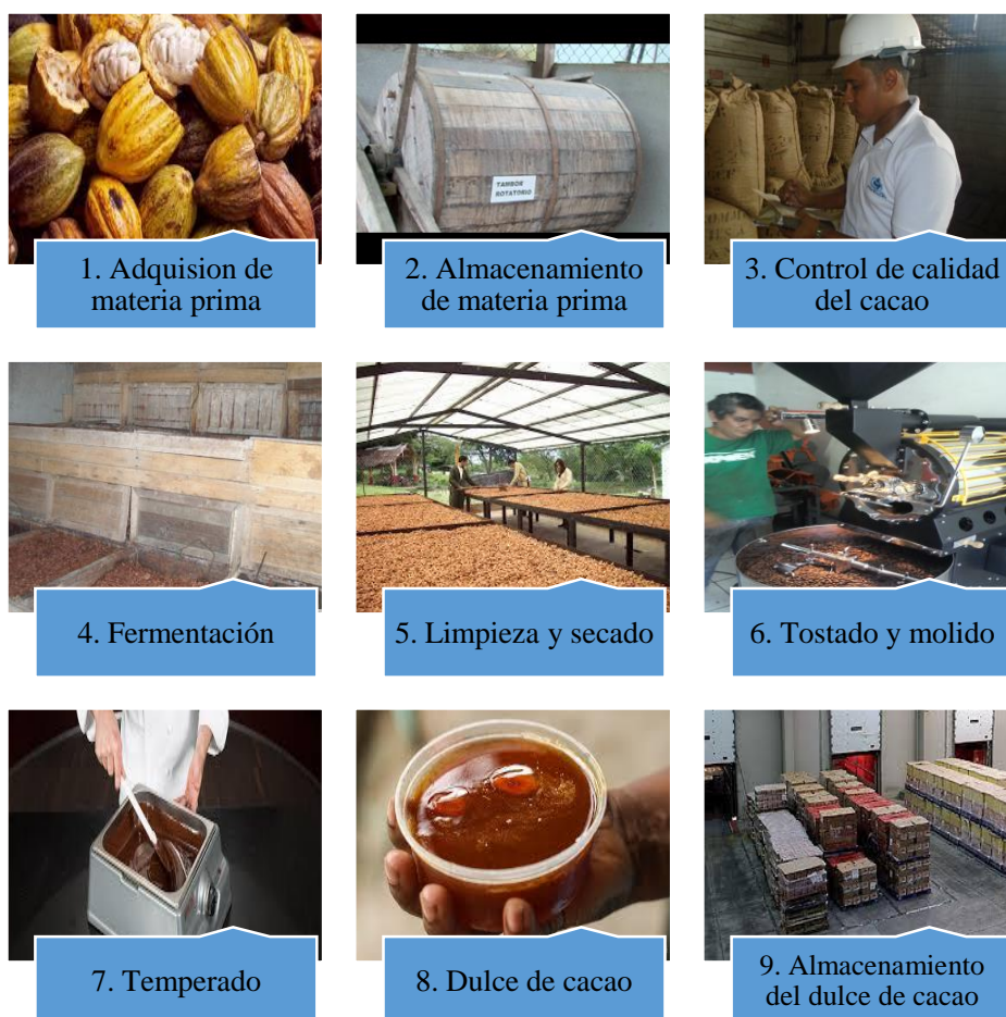
Figura No.9 Diagrama del proceso de producción del dulce de cacao.
