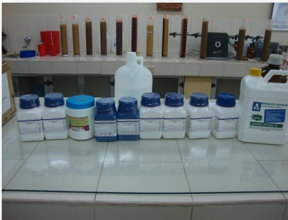
Apéndice 17. Reactivos utilizados en el Laboratorio de suelos para determinar la Materia Orgánica y Capacidad de Intercambio Catiónico (CIC)
