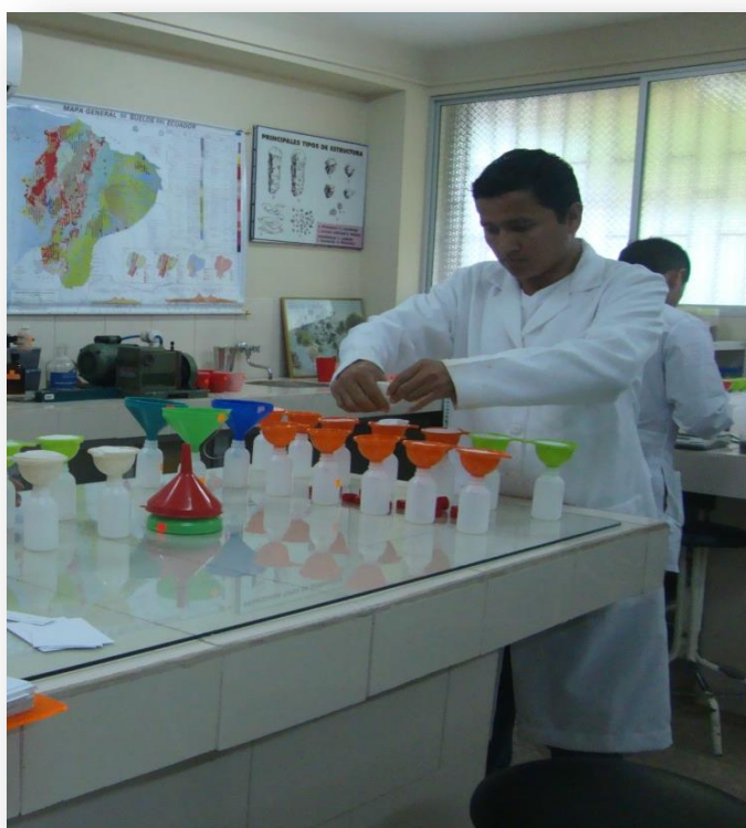
Apéndice 8. Preparación de las botellas de polietileno para Capacidad de Intercambio Catiónico
