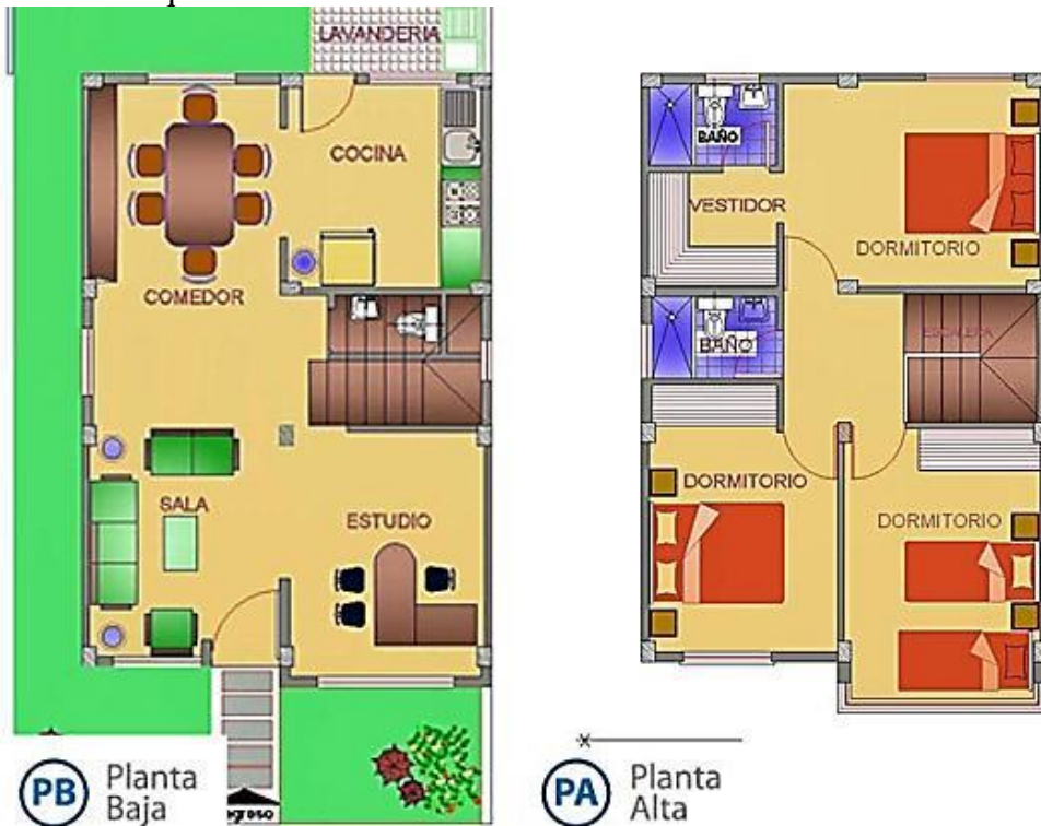
Figura 7. Plano arquitectónico de vivienda de dos niveles.
