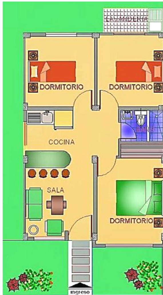
Figura 5. Plano arquitectónico de vivienda de un nivel.
