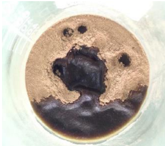
Figura 10 : Modificación de la cascarilla de arroz con ácido fosfórico al 85 por ciento
