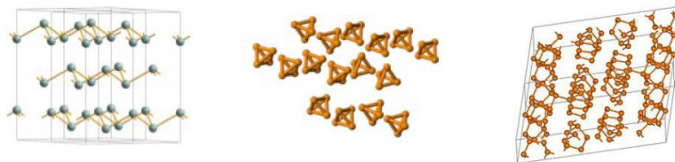
Figura 3 : Formas alotrópicas del As y sus estructuras: de izquierda a derecha: gris, amarillo y negro
