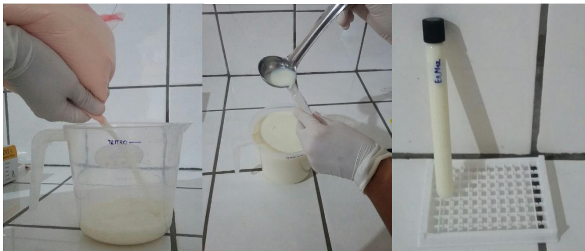
Gráfico 6.1.3. Colocación de la muestra en jarra medidora, homogenización de la muestra y llenado de tubo de ensayo.
