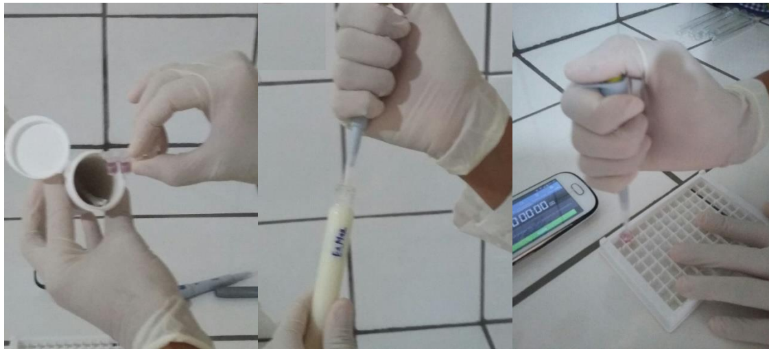
Gráfico 6.1.4. Toma del pocillo de reacción, toma de muestra de 200 ul con micropipeta, colocación y homogenización de la muestra en el pocillo.
