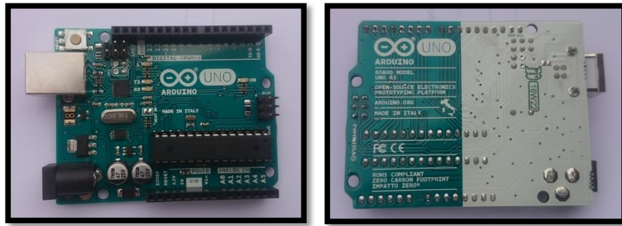
Imagen 4. Tarjeta Arduino ONE Versión R3
