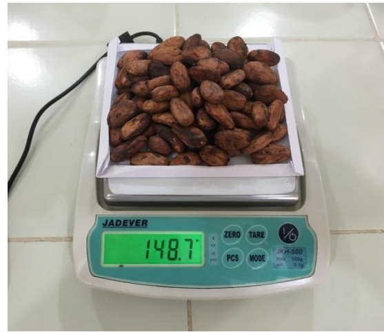
Foto 15. Determinación del índice de grano.
