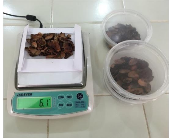
Foto 17. Determinación del porcentaje de testa.
