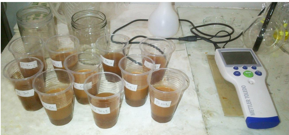
Foto 14. Determinación de pH.
