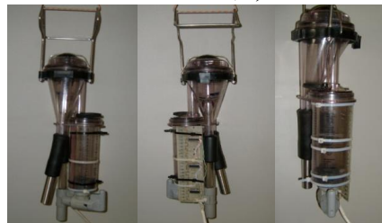
Figura 2. Fotografías del sistema electrónico y de su ubicación en el medidor proporcional, a) una vista de frente, b) vista posterior, mostrando parte de la matriz de sensores de efecto Hall, c) vista lateral
