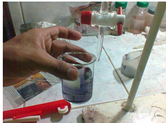
Anexo 8. Análisis de concentración de cianuro y tiourea por volumetría.
