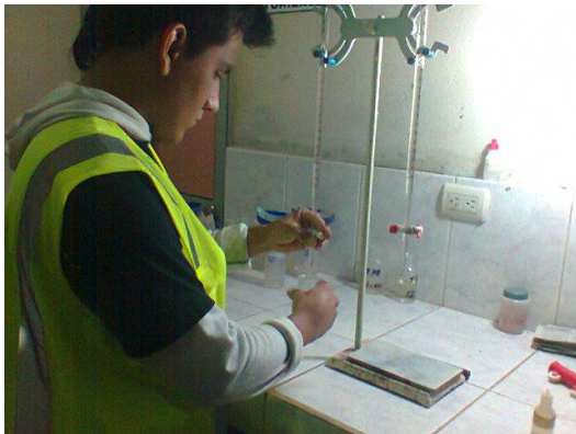
Anexo 8. Análisis de concentración de cianuro y tiourea por volumetría.
