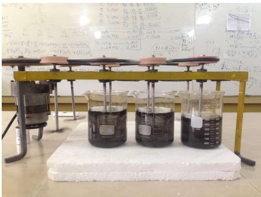
Figura 14. Proceso de Agitación de las Soluciones Acuosas de Plomo y Mercurio en Carbón Activado
