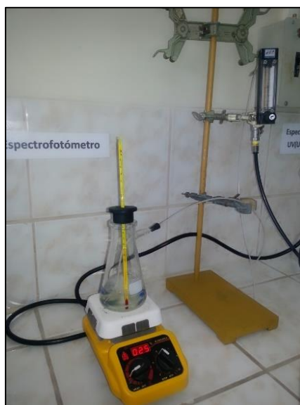
Figura 19. Abatimiento de Cianuro con Peróxido de Hidrógeno.
