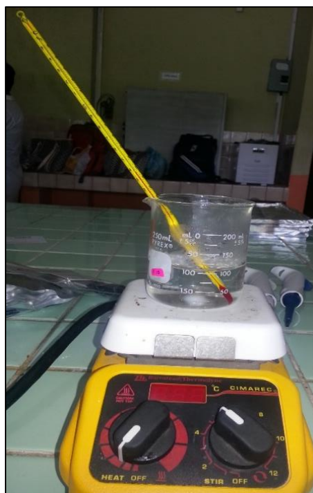
Figura 22. Abatimiento de Tiourea con Peróxido de Hidrógeno.
