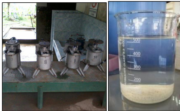
Figura 18. Toma de residuos líquidos cianurados y tioureados provenientes del proceso de adsorción.
