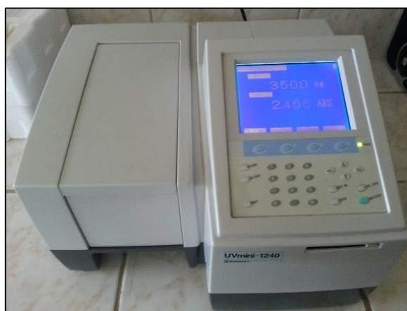
Figura 21. Determinación de Cianuro y Peróxido de Hidrogeno en Espectrofotómetro UV-VIS (1240-ZHIMADZU).
