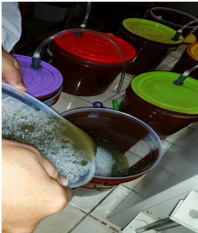
**Anexo 3.** Inoculación de la levadura en los bioreactores
