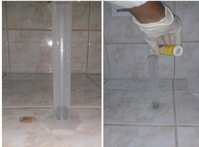
**Anexo 8.** Determinación de la densidad de las semillas de cacao después de ser acondicionadas para su molienda utilizando el método de Arquímedes para determinar la densidad de sólidos.
