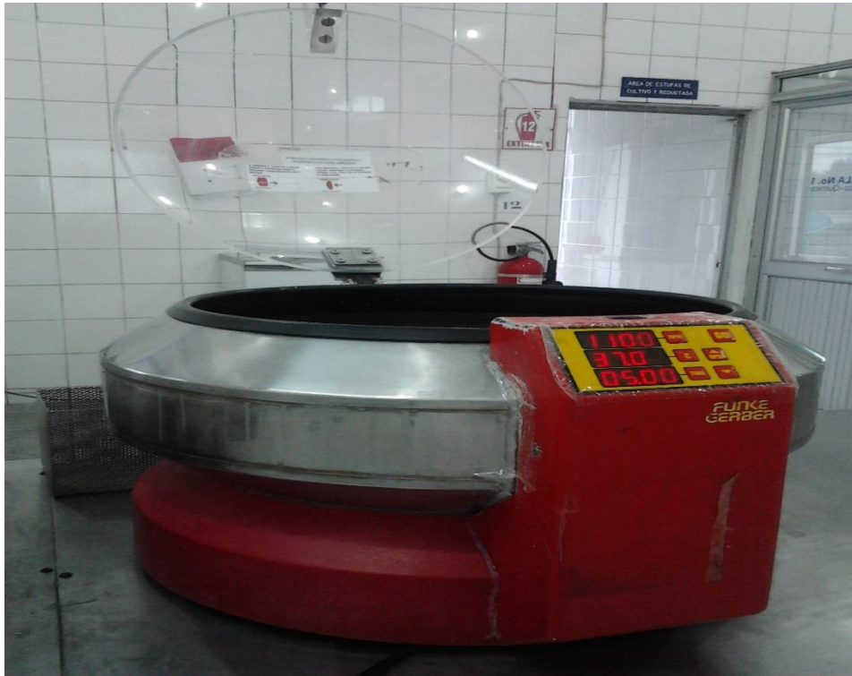
Figura 28. Centrifuga, para determinar contenido de grasa en el suero lácteo, marca Funke Gerber.
