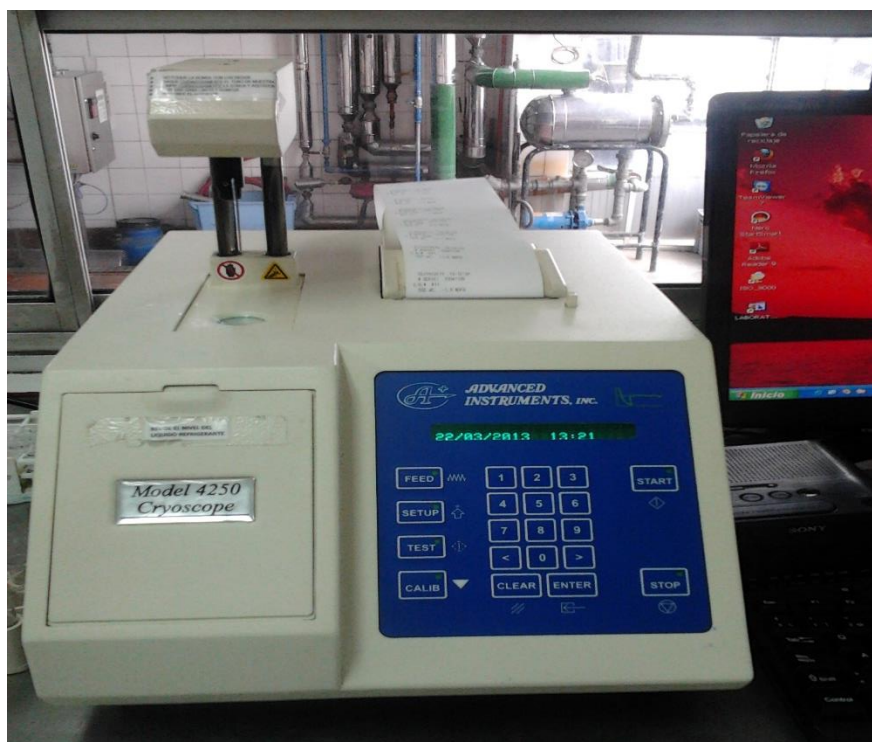
Figura 27. Equipo de Crioscopia modelo 4250, medición del punto de congelación del suero de leche.
