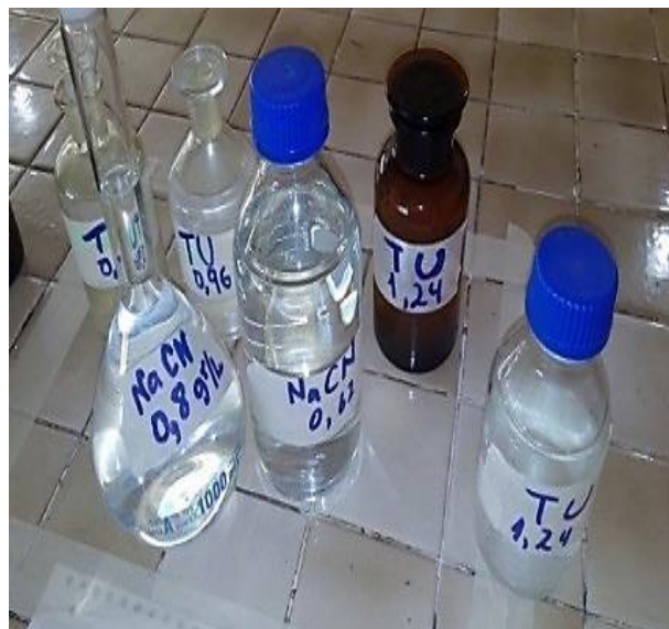
Figura 19. Medios corrosivos preparados a distintas concentraciones de Cianuro y Tiourea para someter las muestras de acero.
