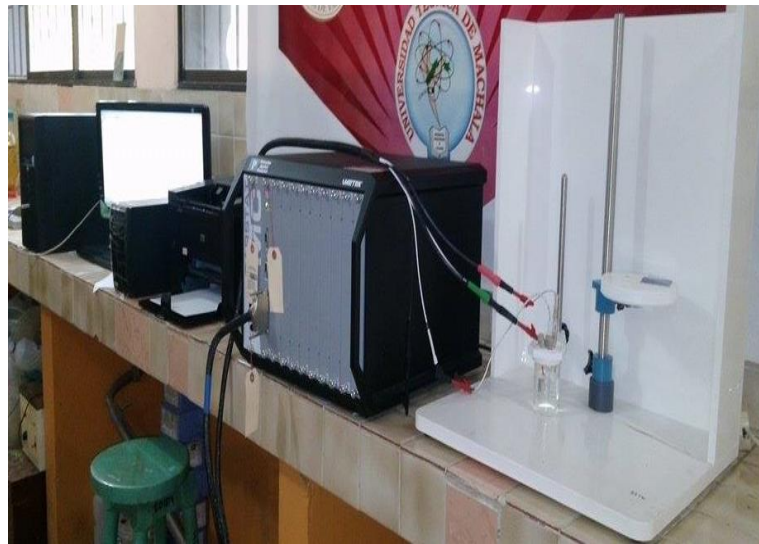
Figura 11. Potencióstato marca Parstat MC
