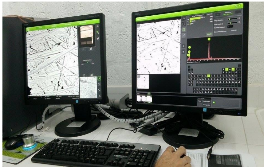
Figura 25. Análisis elemental de la muestra metálica expuesta a la solución Cianuro a 0,62 g/L
