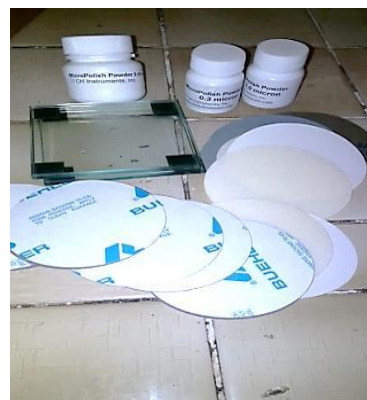
Figura 20. Kit de pulido especial para electrodos.
