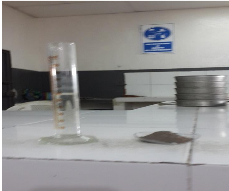
Anexo 7. Probeta con 80 ml de agua y 60 gr de materia prima ya pesada.
