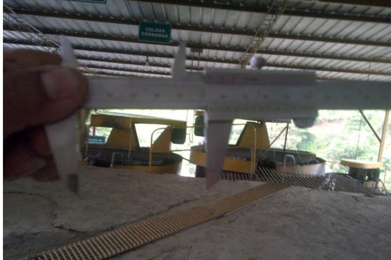
Anexo 5. Lectura de una bola de acero con “el calibrador vernier” dándonos una medición de 2 pulgadas.
