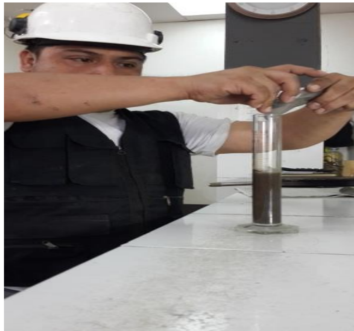
Anexo 7. Probeta con 80 ml de agua y 60 gr de materia prima ya pesada.
