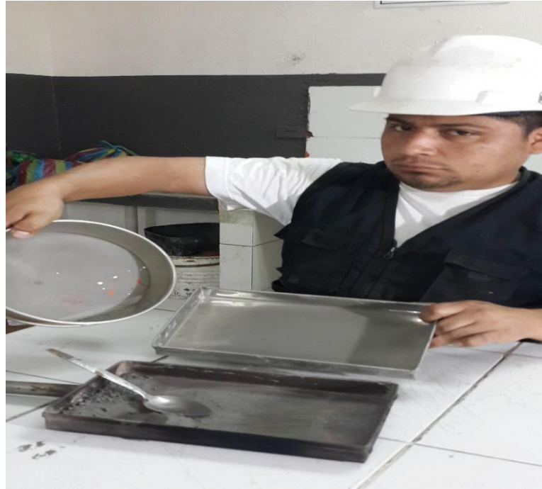
Anexo 12. Residuos de material en el tamiz como también en el recipiente de recepción del material fino comprobando el grado de molienda y eficiencia del molino.
