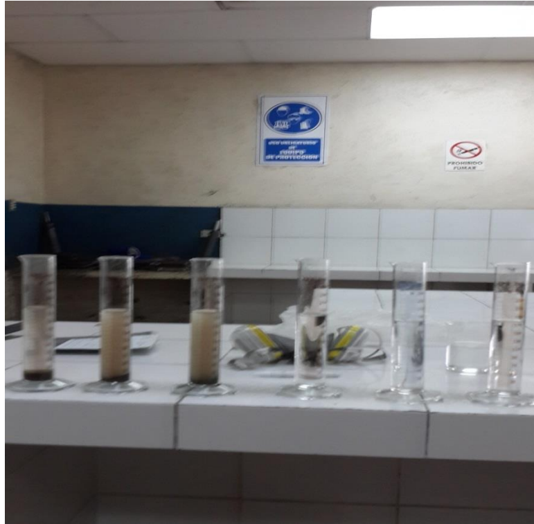
Anexo 9. Dejando la muestra en reposo para poder dar lectura a la gravedad específica del material.
