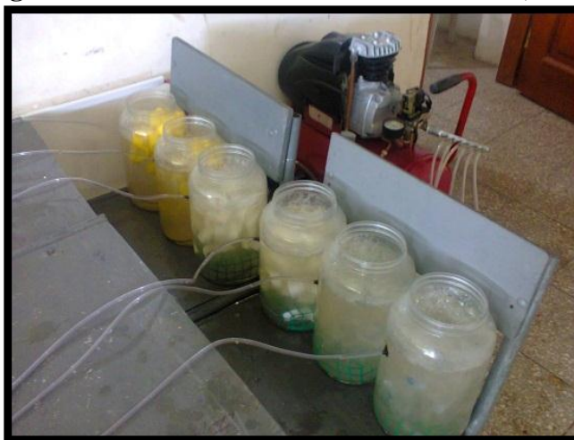
Figura 32. Reactores aerobios de lecho móvil (MBBR).
