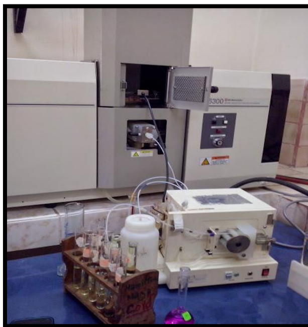
Figura 9. Lecturas en Espectrofotómetro de Absorción Atómica.
