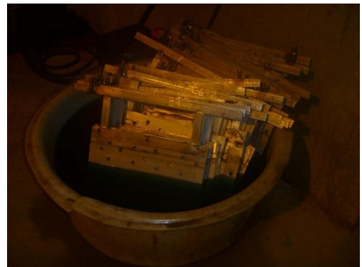
Limpeza de ánodos para su reutilización
