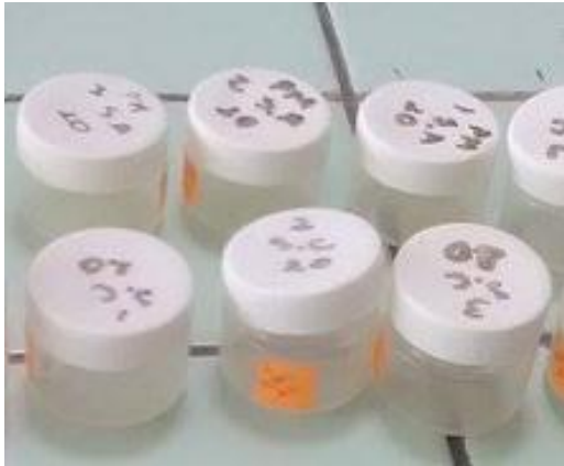
FRASCOS EN DONDE SE COLOCO LA MUESTRA PESADA, Y SE REALIZA DIGESTIÓN ACIDA DE LAS MUESTRAS.
