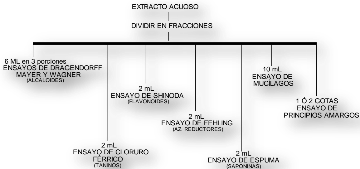
Figura 7. Esquema de reacciones a realizar en el extracto acuoso.
