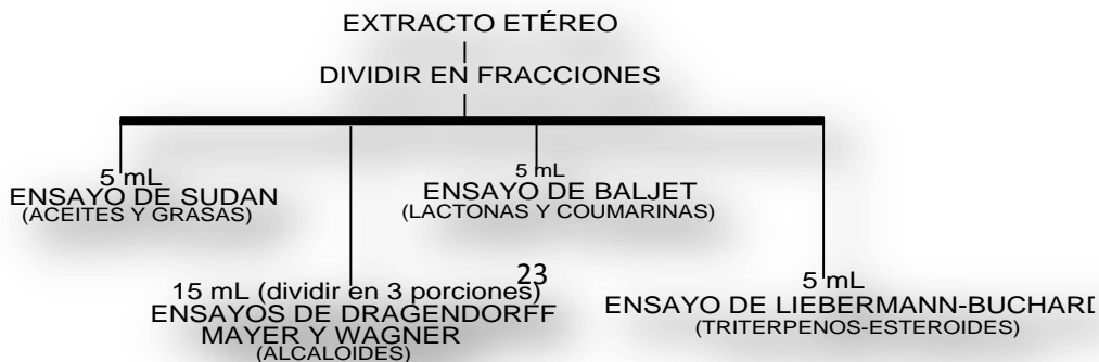
Figura 5. Esquema de reacciones a realizar en el Extracto de Éter Etílico
