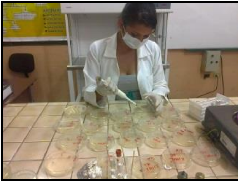
Foto 21. Llenado de los pocillos con concentraciones establecidas del extracto y de muestra patrón.
