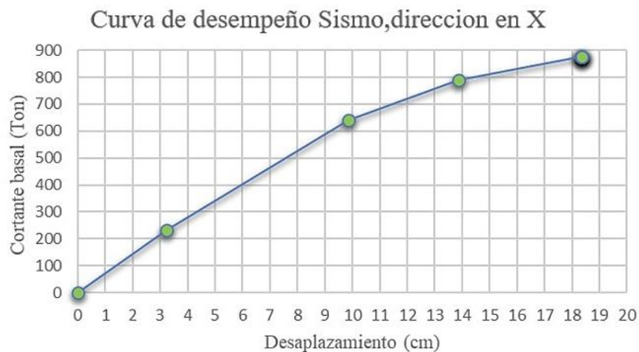
Ilustración 104 Curva de desempeño sísmico, dirección X
