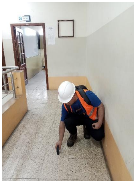
Anexo 6. Medición de altura de piso en la 2da planta alta
