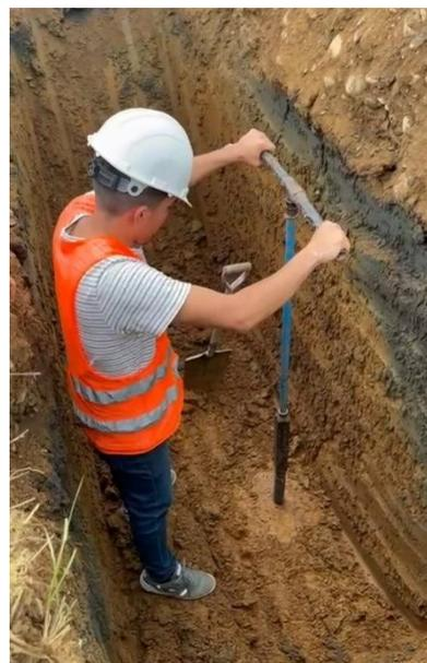
*Ilustración 27. Extracción de tubos shelby, sondeo N°2*
