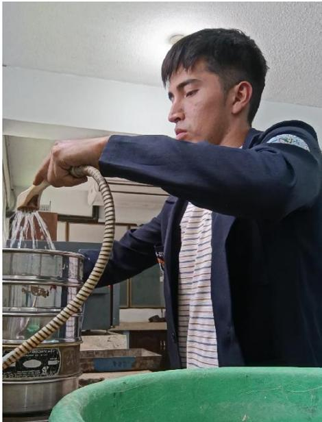
*Ilustración 31. Preparación de la muestra para Granulometría método de lavado*
