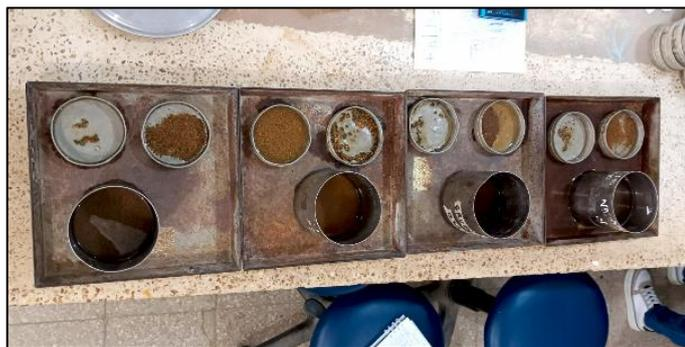
*Ilustración 34. Tamizado de muestras Para limite plástico*
