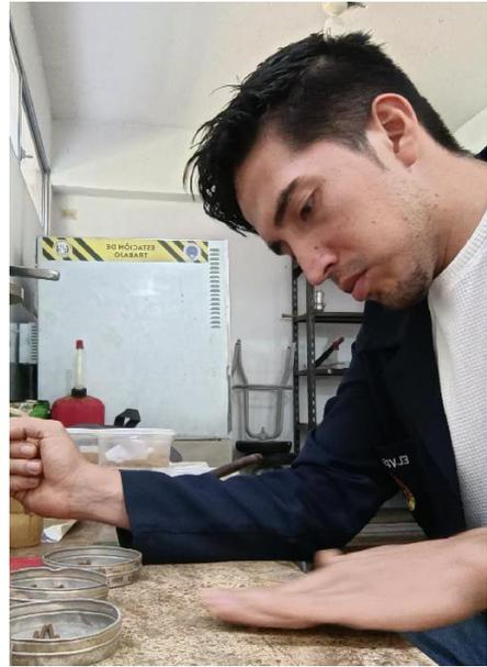
*Ilustración 36. Muestras de ensayo de Limite Liquido*
