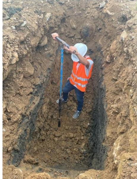
*Ilustración 29. Extracción de muestras de los tubos shelby*
