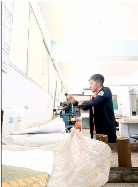
*Ilustración 28. Ensayo de limite liquido*
