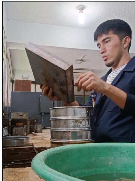
*Ilustración 33. Muestras obtenidas de granulometría (Por lavado)*
