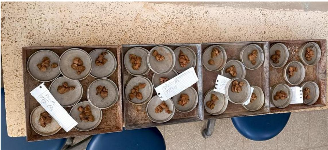
*Ilustración 37. Colocación de muestras de suelo en el horno*
