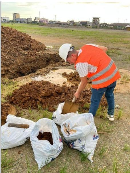
*Ilustración 25. Extracción de tubos shelby sondeo N.1*
