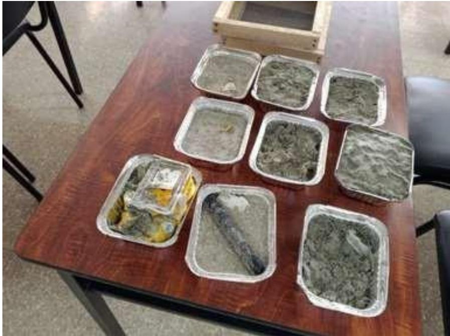
Fig. 17. Muestras secas preparadas para el proceso de tamizado tras el secado en horno.
