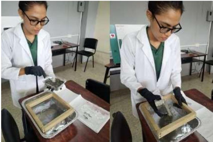
Fig. 18. Proceso de tamizado de las muestras de arena para la separación de macroplásticos, seguido del almacenamiento de los residuos plásticos recuperados para su posterior caracterización.
