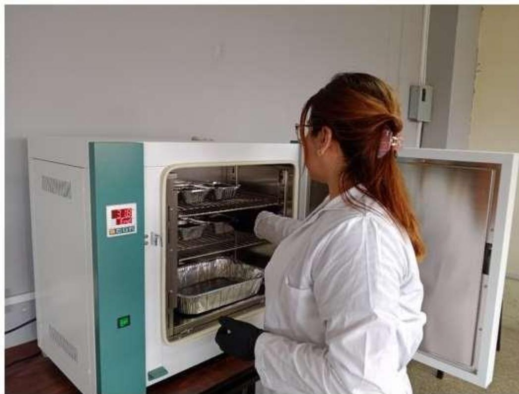
Fig. 16. Proceso de secado de muestras de arena húmeda mediante horno a temperatura estandarizada.
