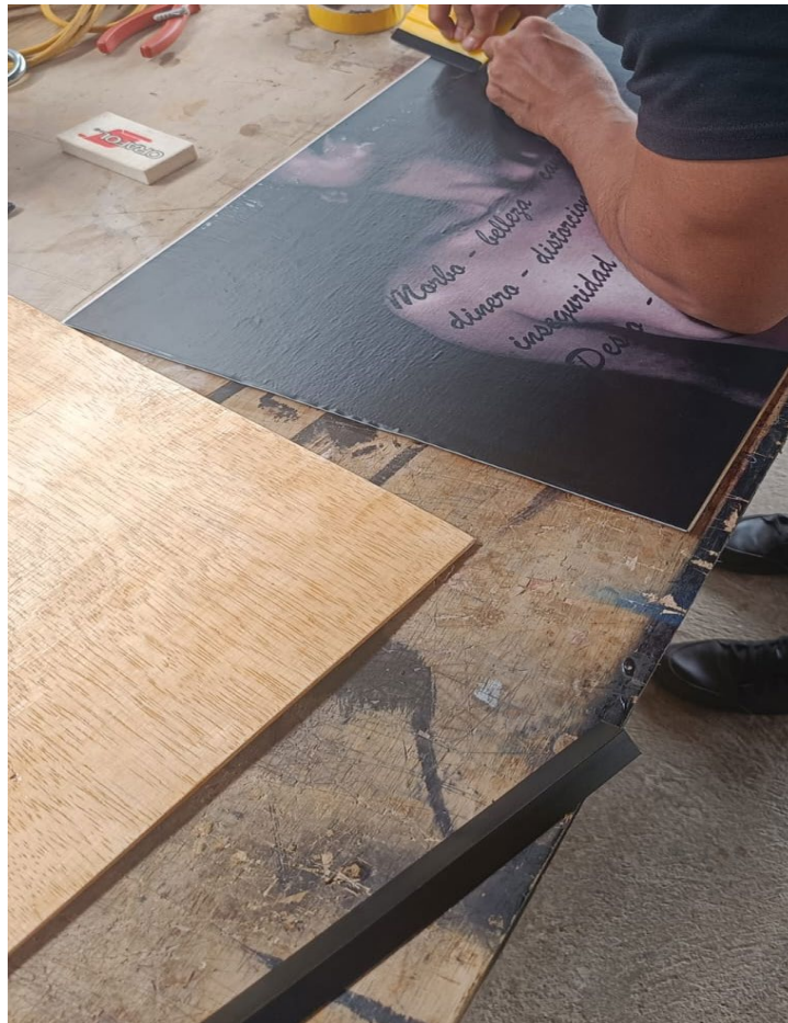
Figura 21: Adherencia de fotografía en vinil al soporte
