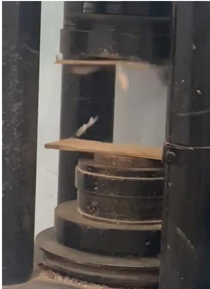
Anexo 8. Fémur sometido a compresión
