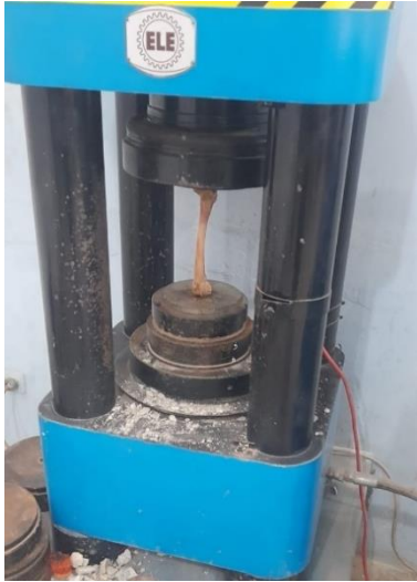
Anexo 6. Colocación de fémur en equipo de compresión
