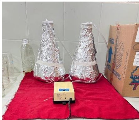
Figura 6. Masificación de Azospirillum spp. en dos medios de cultivo mediante sistema de aireación continua.
