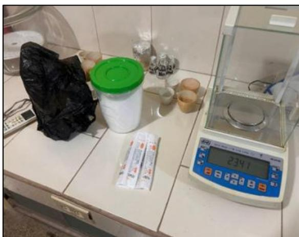
**Anexo 11.** Pesaje de SPC y peróxido de hidrógeno en la balanza analítica.
