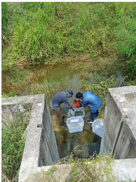
Anexos. 9. Filtración del agua mediante bolso de 5 micras
