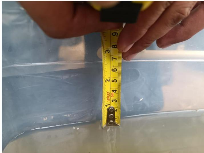
Anexos. 22 Reposición con agua destilada para mantener el volumen de agua (30L) en los recipientes y de esta forma poder compensar las pérdidas por evaporación.
