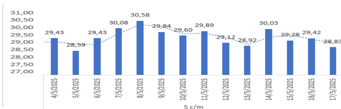
Figura 6 Temperatura en la superficie del estanque sin manta solar (cobertura del 25%)
