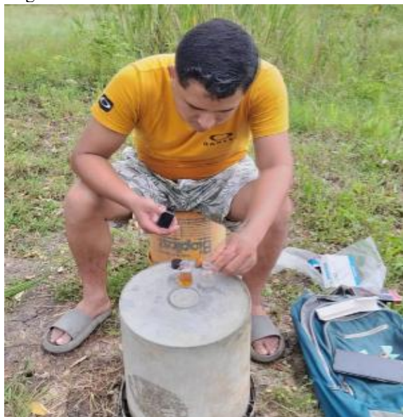
Figura 20 Medición del oxígeno disuelto en el agua durante el experimento, con el kit indicador de oxígeno monitor DO.
