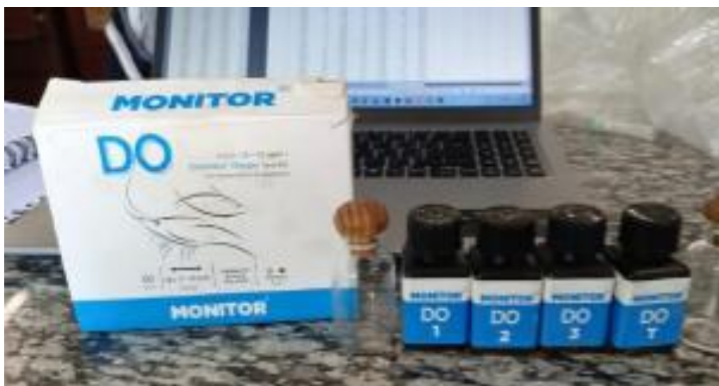
Figura 33 Equipo de medición de oxígeno disuelto, kit colorimétrico Monitor DO.
