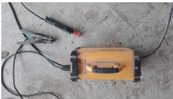
Ilustración 20 máquina para soldar parte de la escultura en chatarra Fuente: del autor 24/01/2024
