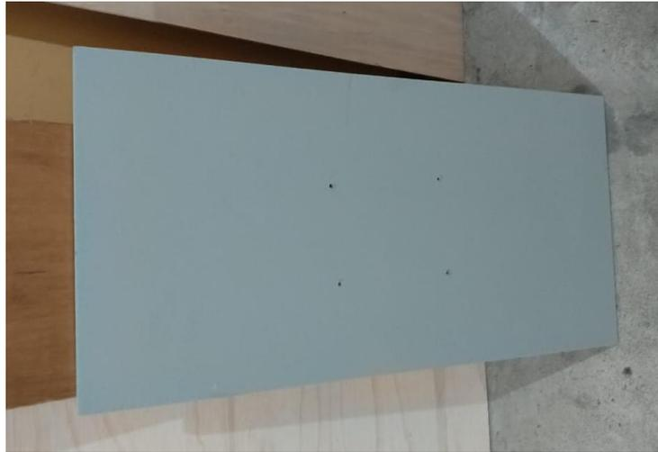
**Imagen 18** Fondeo de la plancha de plywood
