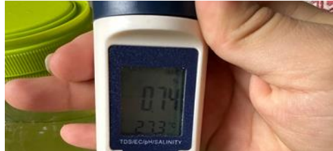
Ilustración 8 Resultado de variación de Amoniaco ( \text{NH}_3 ) medido con Checker HC (HI715)
