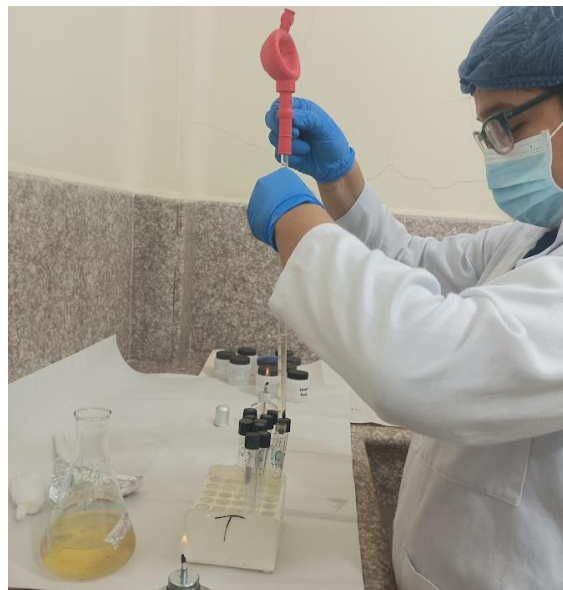
Figura 8. Dispensación de diluciones de 1/10, 1/100, 1/1000
