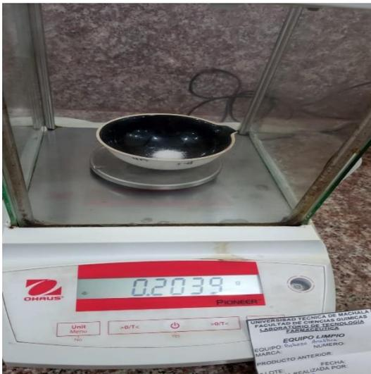
Ilustración 5 Pesado de metilparabeno.
