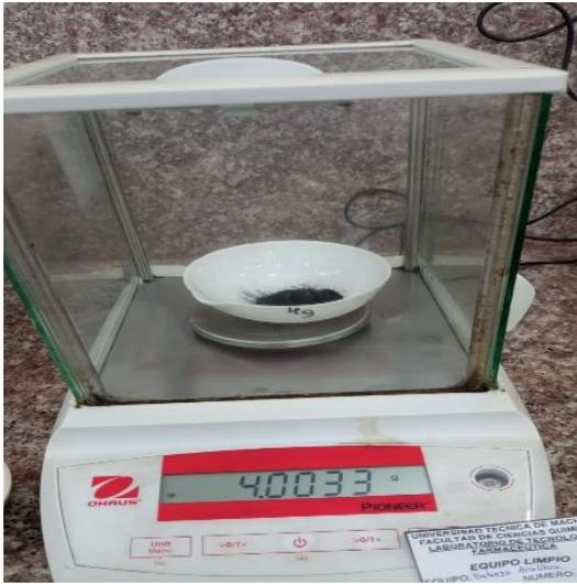
Ilustración 3 Pesaje del carbón activado.
