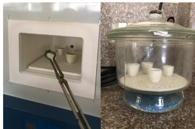
Figura 15 Determinación de cenizas
