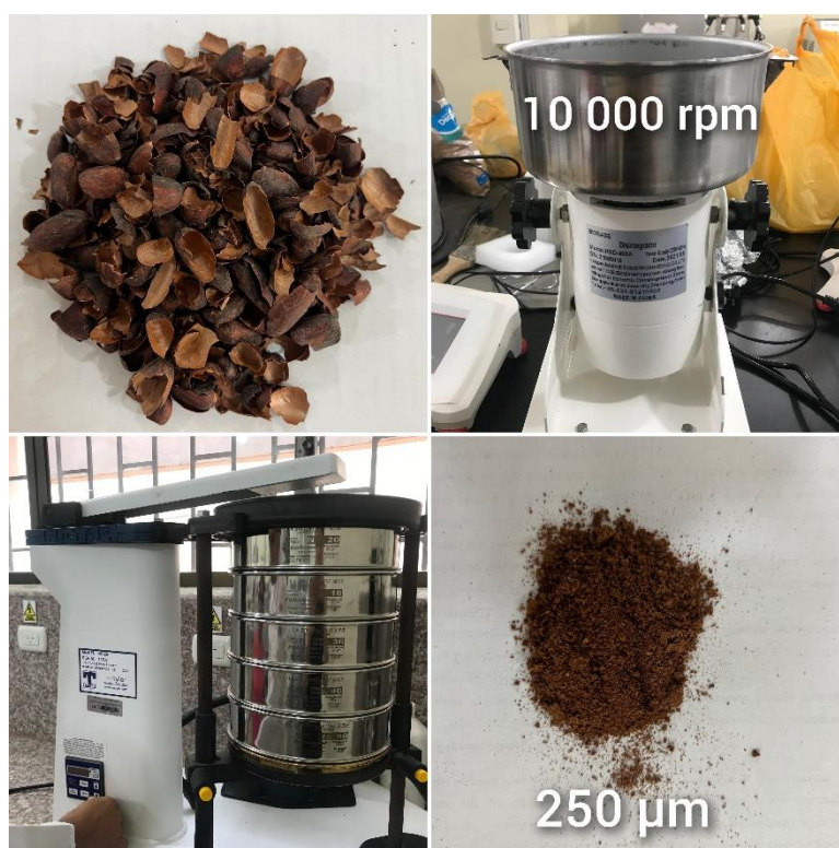
Figura 20 Proceso de reducción de tamaño de partícula ( \leq 250 \mu\text{m} )
