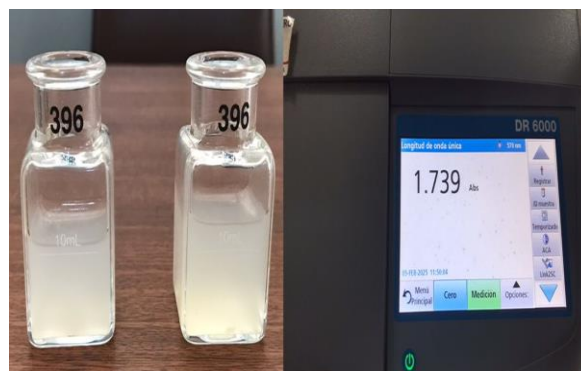
Figura 19 Medición de fibra por espectrofotometría DR 6000 UV-VIS
