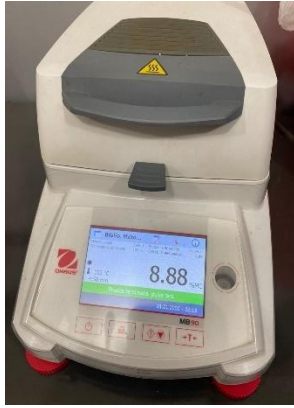
Anexo 5. Medición de humedad en semilla de granadilla
