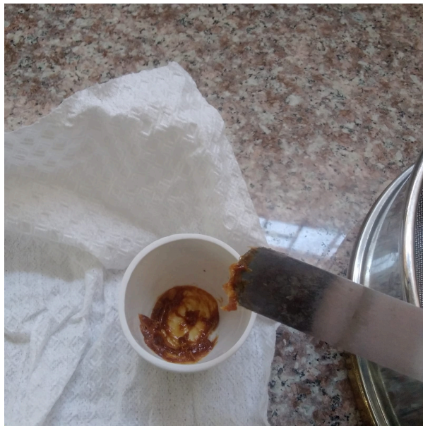
Muestra saturada con Sulfato de Sodio
