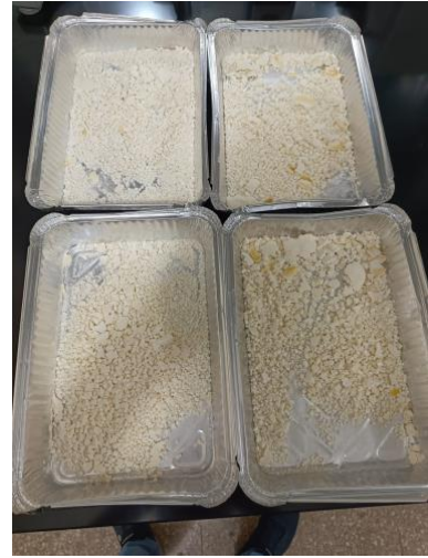
Anexo 10. Almidón seco transcurridas las 5 horas
