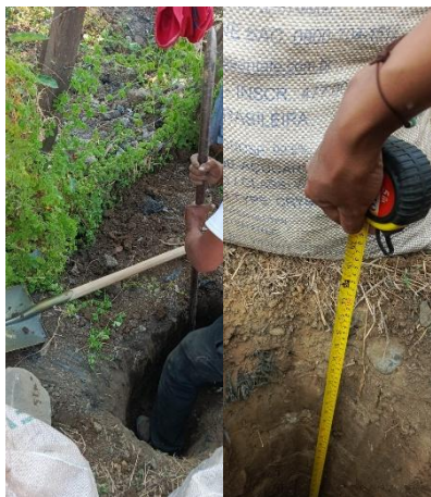
Figura 8. Obtención de muestra de suelo para realizar ensayos -M1
