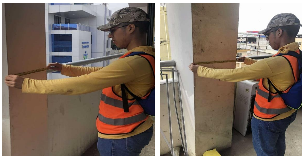
Ilustración 46.- Medición de sección de columnas en 2da planta alta o terraza del Bloque N°2.
