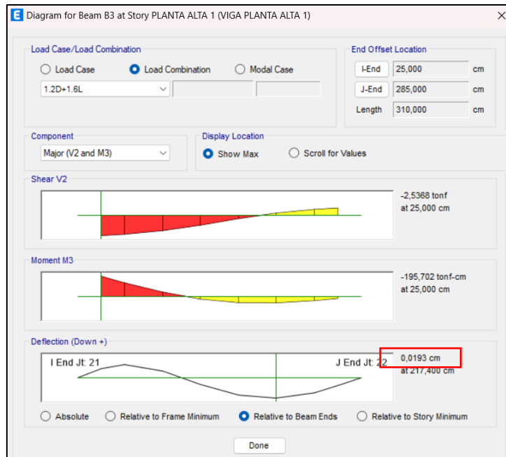
Ilustración 50: Determinación de deflexión máxima en viga más cargada
