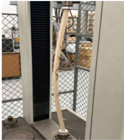
Ilustración 9: Desempeño elástico de una tira de manera bajo compresión
