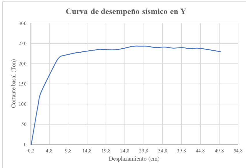
Ilustración 77: Curva de desempeño sísmico, dirección Y
