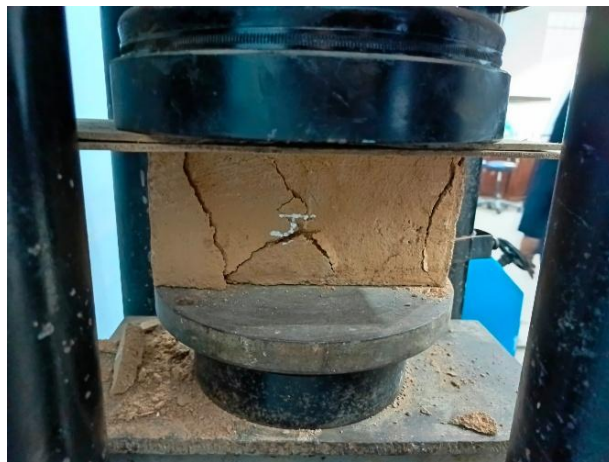
Figura 8 Ensayo de resistencia a la compresión en ladrillos
