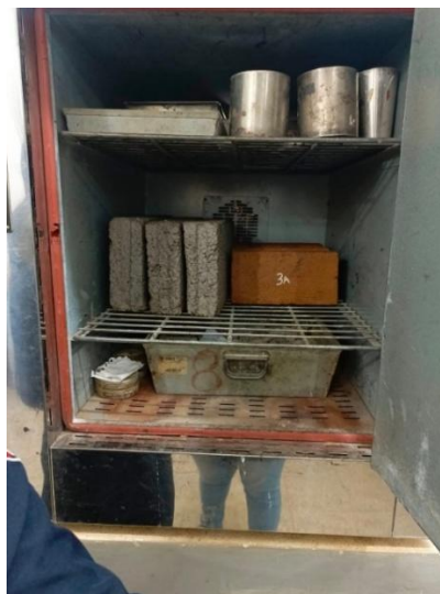
Figura 9 Secado de ladrillos en horno
