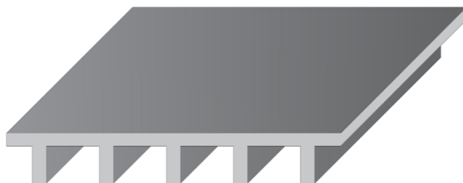
Ilustración 4. Losa Nervada en una dirección.
