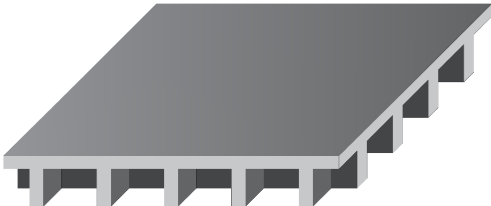
Ilustración 5. Losa Nervada en dos direcciones.
