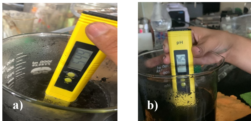
Fig. 9. Neutralización del biocarbón: a) pH antes del lavado con agua destilada, b) pH después del lavado con agua destilada.
