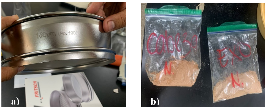
Fig 6. Tamizado de la materia prima: a) tamiz 150 \mu\text{m} y b) biomasa de cabeza y exoesqueleto de camarón
