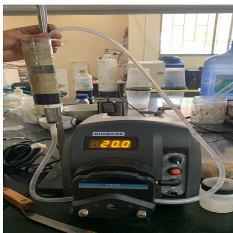
Fig. 105. Bomba peristáltica operando conectado con el filtro.
