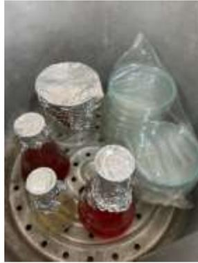
*Ilustración 8 Autoclavado de materiales de laboratorio*
