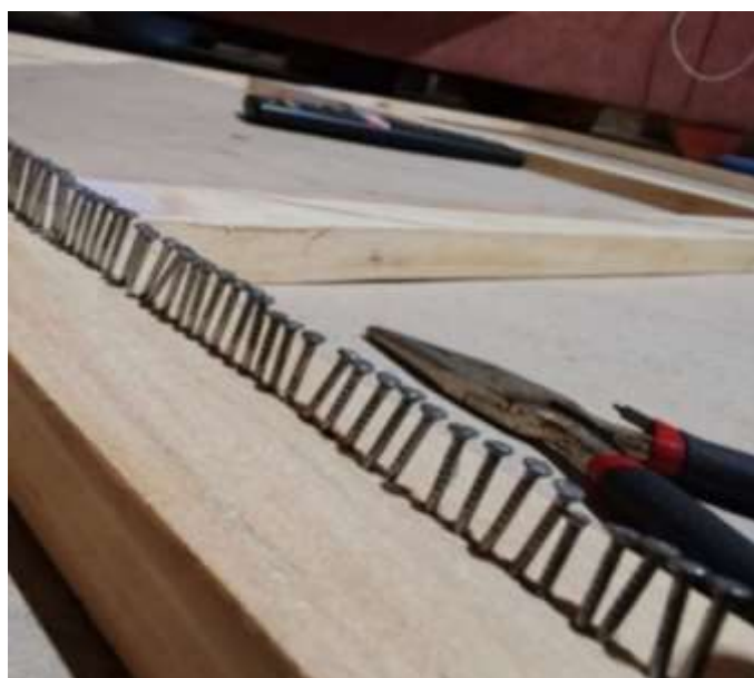
Ilustración 28: Colocación de los clavos al contorno del bastidor. Fuente: La autora
